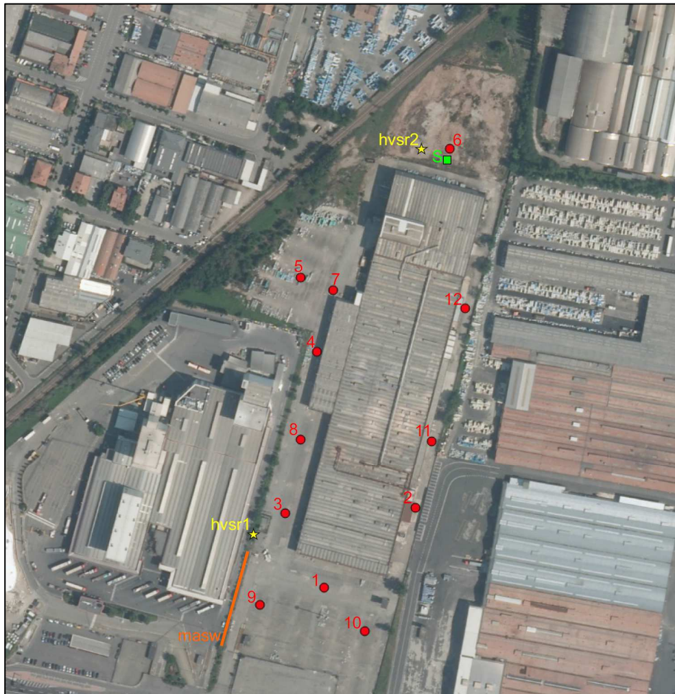
Figura 20 - Ubicazione delle indagini geognostiche e sismiche eseguite per la Caratterizzazione geologico-geotecnica e sismica dell'area in esame (a cura di GEO GROUP s.r.l.).
