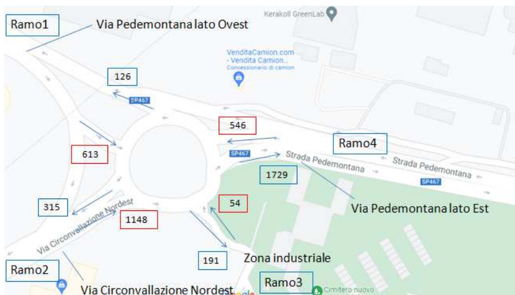
Flussi in ingresso ed in uscita sulla rotatoria via Pedemontana-Circonvallazione Nordest nell'ora di picco mattutina 07.30-08.30 in veic eq./h- scenario LT senza flussi aggiuntivi - (tot. flussi circolanti: \approx 2.361 veic eq/h)- Fonte sfondo: Google Maps
